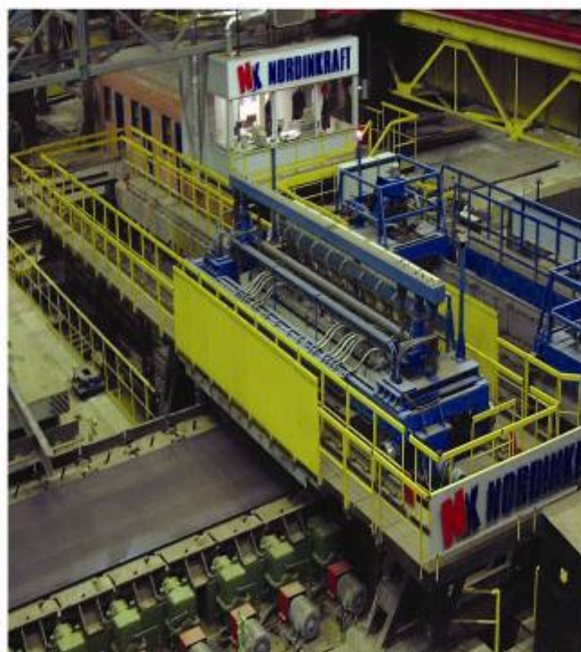
图 10：在俄罗斯“Severstal”钢厂第 3 轧钢车间的钢板检测 EMASCAN 系统
