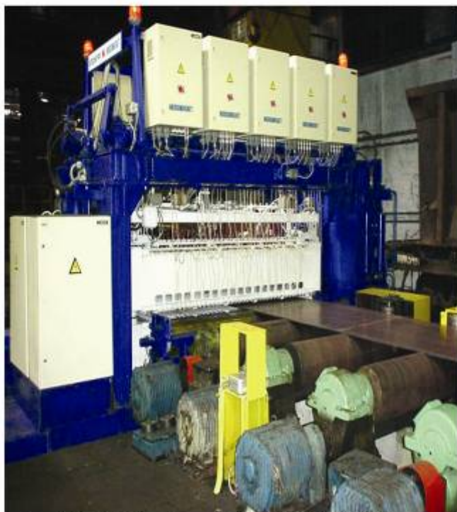
图 9：在俄罗斯 Magnitogorsk 钢铁厂的钢板检测 EMASCAN 系统
