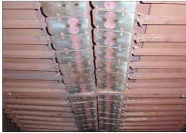
图14: 在乌克兰 Alchevsk 钢铁厂的 EMASCAN 设备的检测探头组合, 带有公共磁体的 EMAT 探头
