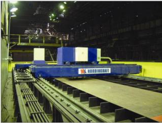
图11: 在俄罗斯“Severstal”轧钢厂工作的离线钢板超声波探测设备 EMASCAN ® -PL
