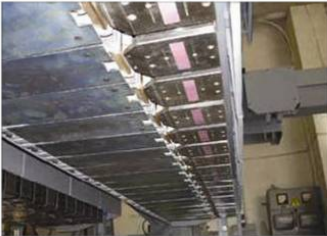
图13: 在Ural钢厂 EMASCAN 设备的检测探头组合, 带有独立磁体的 EMAT 探头
