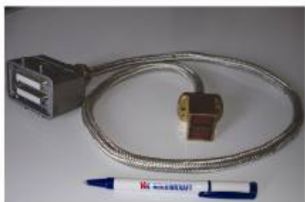
图 5: 16 - 通道转能器 - 压电相控探头
