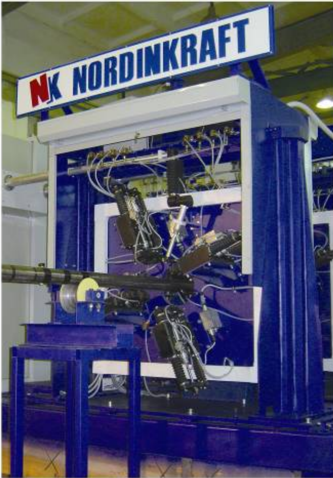
图15: 《EMATEST-BB-6》— 在 Nordinkraft 车间里, 为俄罗斯 Mechel 钢厂生产的超声波检测设备
