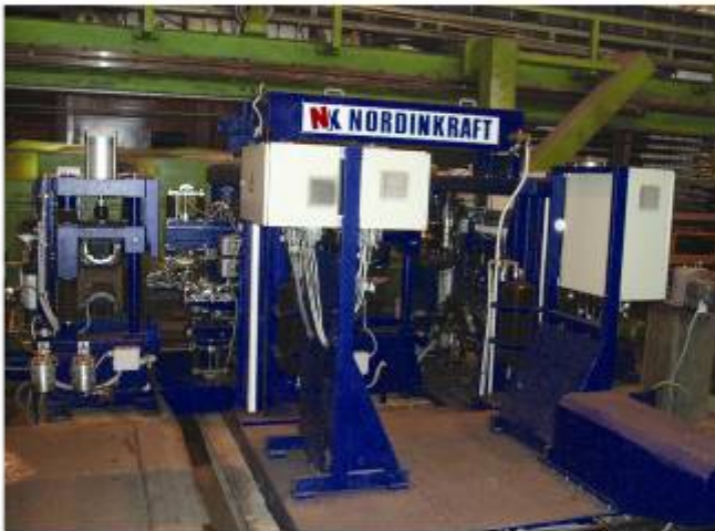
图10: 《EMATEST-BB-7》—— 检测方钢和圆钢，白俄罗斯钢铁厂
