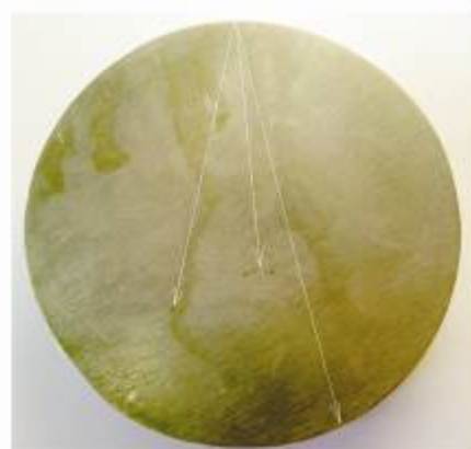
图 7: 115 毫米直径棒材, 含非金属物
