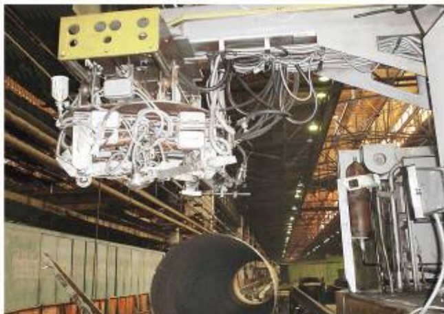
图10：在俄罗斯 Volzhsky 钢管厂给螺纹焊管检测的“EMATEST-PI-1-16”设备
