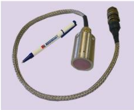
图2：用于焊缝（1.0MHz）和管端（5.0MHz）检测的EMAT探头
