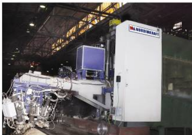
图11：在俄罗斯 Volzhsky 钢管厂螺纹焊管进行超声波探伤 EMATEST-PI-16-002 设备
