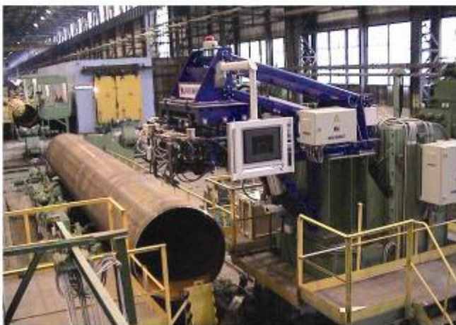
14：俄罗斯 Volzhsky 钢管厂螺纹焊管的超声波“EMATESTPI-16-002”检测设备
