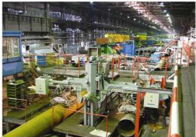
图16: 纵向焊管的“EMATEST-PI-16-002”设备。在俄罗斯的 Chelyabinsk 钢管厂 820 生产线上 2 条平行布置的“EMATEST-PI-16-002”检测系统
