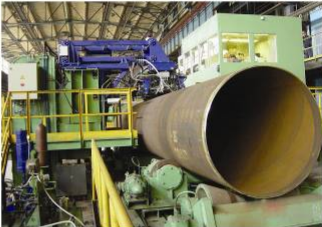
图15: 俄罗斯 Volzhsky 钢管厂的螺旋焊管的超声波检测设备“EMATEST-PI-16-002”
