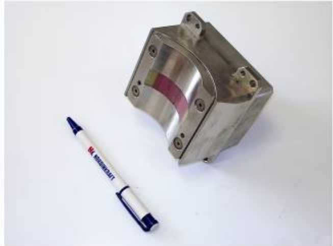
图18: 6 通道 EMAT 探头 (检测分层和测量管壁厚度)
