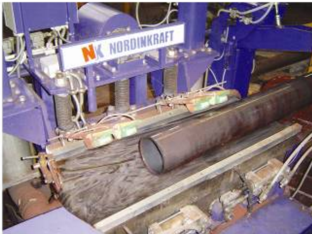
图 13, 14: 在俄罗斯 Synarsky 钢管厂,《EMATEST-TU-8》对无缝钢管进行超声波检测
