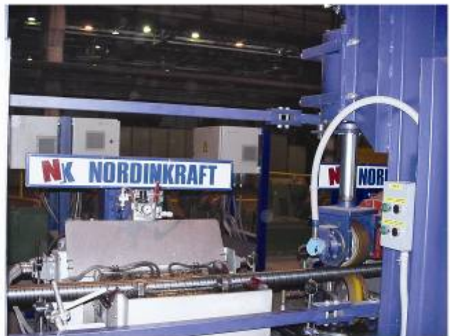
图 16: 在俄罗斯 Volzhsky 钢管厂,《EMATEST-TU-8》给无缝钢管进行超声波检测
