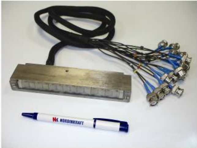
图17: 16 通道的 PEP 探头 (检测纵向缺陷)
