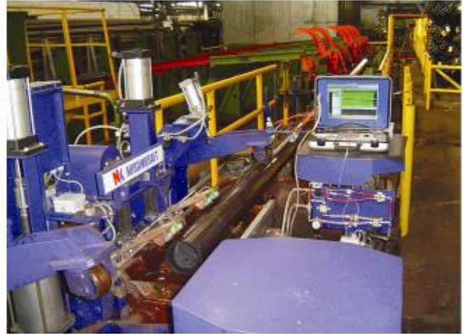
图 13, 14: 在俄罗斯 Synarsky 钢管厂,《EMATEST-TU-8》对无缝钢管进行超声波检测
