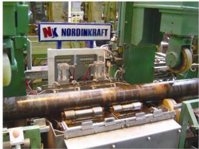
图 12: 在俄罗斯 Volzhsky 钢管厂,《EMATEST-TU-8》给无缝钢管进行超声波检测
