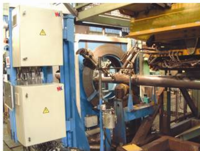
图 2: 《EMATEST-TU-7》系统为电焊管的进行超声波检测 在北俄罗斯钢铁公司
