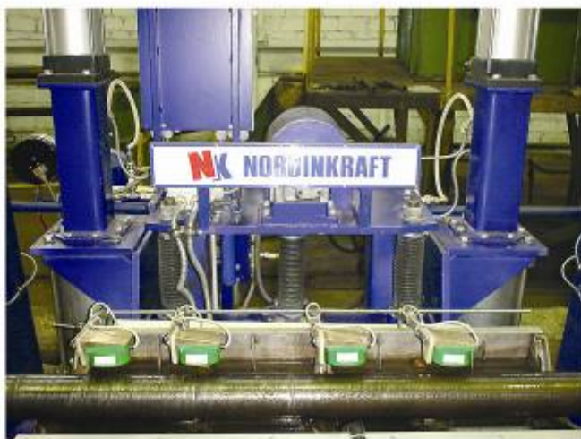
图 15: 在俄罗斯 Volzhsky 钢管厂,《EMATEST-TU-8》给无缝钢管进行超声波检测
