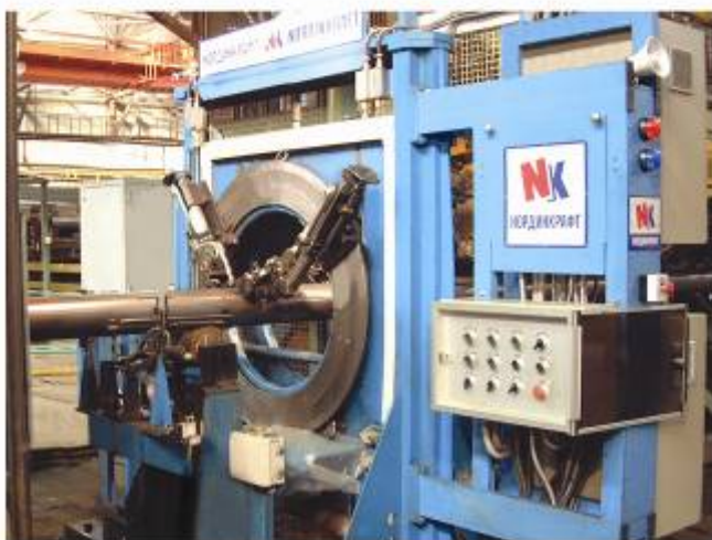
图 1: 《EMATEST-TU-7》系统为纵向焊管的进行超声波检测
