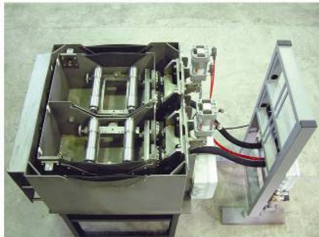
图20: 带有提升机构的浸水箱
